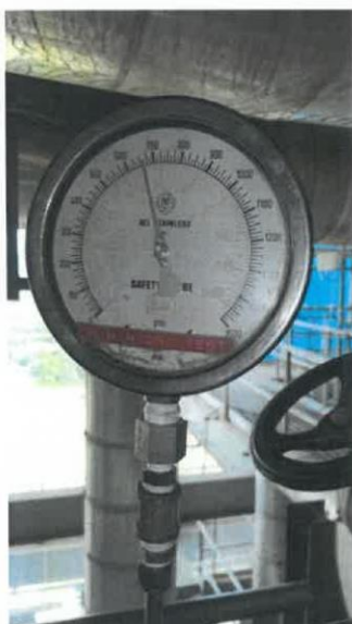
รูปที่ 7 ความดันสูงสุด RH. ที่ใช้ในการทดสอบ ขณะที่ความดัน 95 bar (1.25 MAWP) และ 76 bar (1.0 MAWP)
