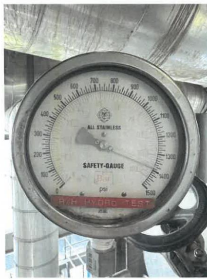
รูปที่ 7 ความดันสูงสุด RH. ที่ใช้ในการทดสอบ ขณะที่ความดัน 95 bar (1.25 MAWP) และ 76 bar (1.0 MAWP)
